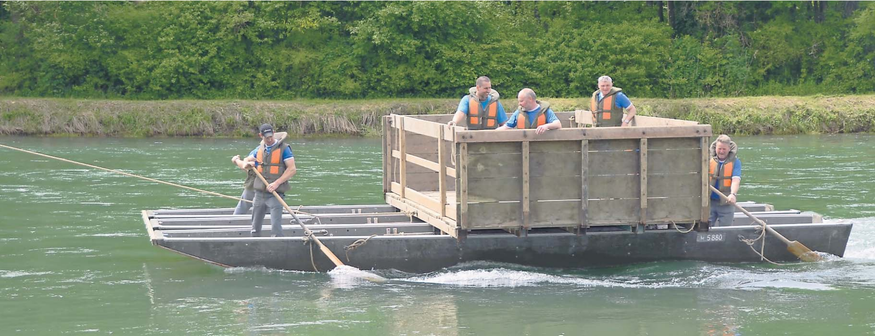
Plattform auf drei Weidlingen: Militärtaugliche Fähre aus früheren Zeiten, von der Strömung getrieben. (Bild Martin Mullis)
